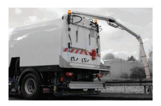
Um eine gründliche Reinigung zu gewährleisten ist eine Wasserdüse am Ende des Saugrohres verbaut.
